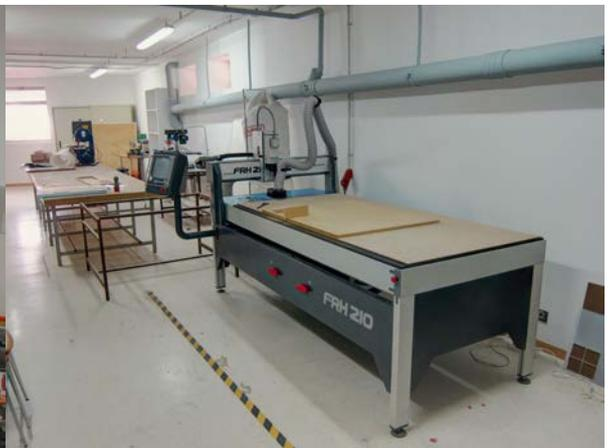
Imagen 17 | Fresadora (fablab)
